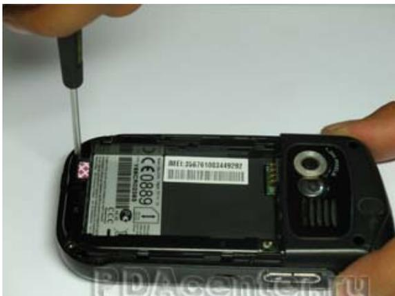
5. Лопаткой отжимаем защелки верхней задней крышки
